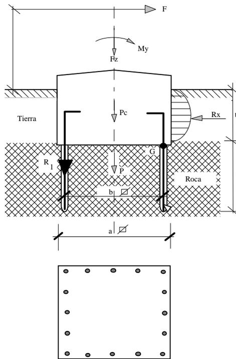
El momento estabilizador debido a las reacciones de las paredes laterales y de los pernos, así como a las del propio peso del cimiento y del apoyo y a las cargas verticales, es el siguiente:
